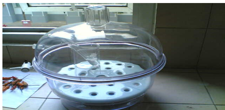
Desikator Pendinginan bahan setelah di Oven
